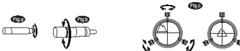
Os buscadores de amplitude fixa, montados no tubo ótico são acessórios muito úteis. Quando propriamente alinhados com o telescópio, objetos podem ser rapidamente localizados e trazidos para o centro do campo de visão. O alinhamento é feito com mais eficácia em campo aberto ao ar livre e durante o dia, quando é mais fácil localizar objetos. Caso seja necessário reforçar seu buscador, focalize em objetos localizados no mínimo a 500 metros de distancia.
